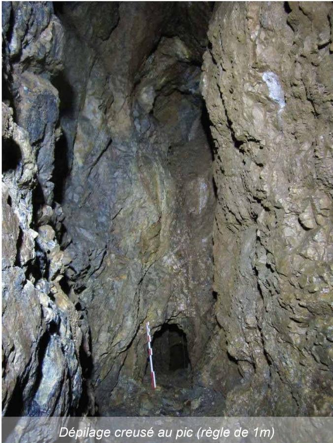
*Dépilage creusé au pic (règle de 1m)*
